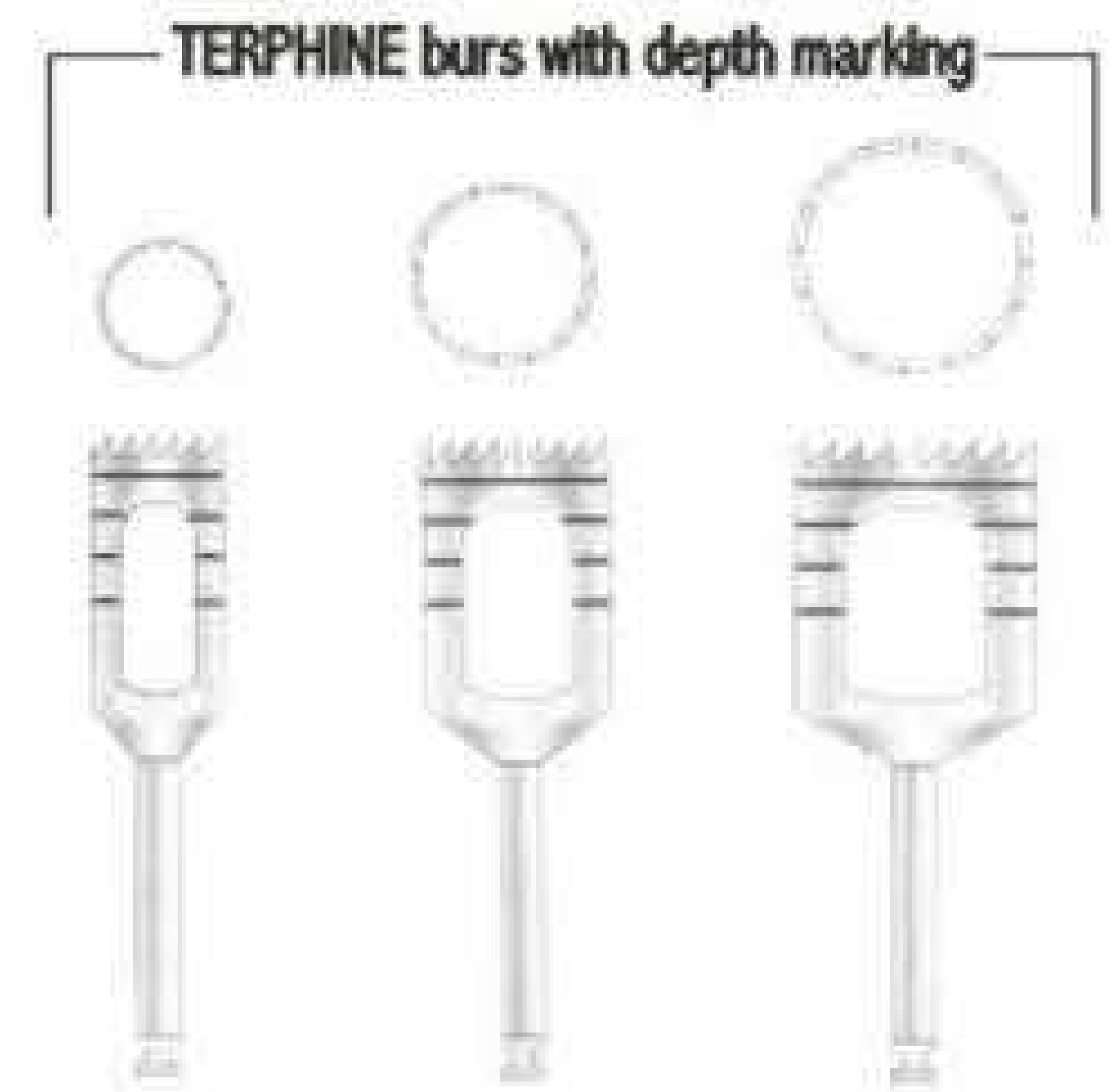
2325 2326 2327 2328 Ext. Ø 3.5 mm Int. Ø 3 mm Ext. Ø 6 mm Int. Ø 5 mm Ext. Ø 8.5 mm Int. Ø 7.55 mm Ext. Ø 11 mm Int. Ø 10 mm
